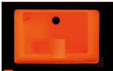
4 Colocar la mufla en el horno con la abertura hacia abajo. Sin contacto con la pared del horno.
