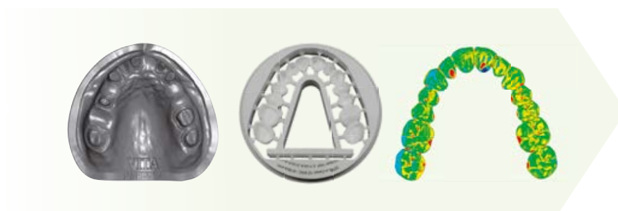
Figura 10a/b/c: a) Modelo; b) construção VITA YZ fresada, de múltiplos elementos; c) Software Wrap com estruturas sobrepostas (da esquerda para a direita)
