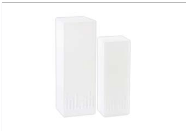
Figura 6: Exemplo de sinterização de encolhimento de cerca de 20% de ZrO_2
