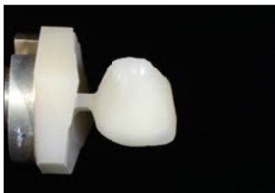
Coroa em estado bruto após a fresagem
